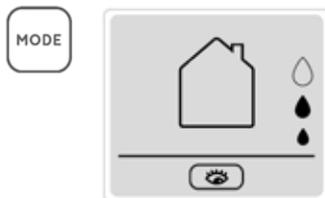
Neste modo, tanto a sonda de humidade como a sonda crepuscular estão activas, as unidades estarão normalmente inactivas com o registo fechado e as sondas activas, de modo que quando a humidade exceder o limiar definido, entrarão em expulsão. Abaixo estão listadas as várias condições em que as máquinas podem ser encontradas com o modo de funcionamento correspondente:
